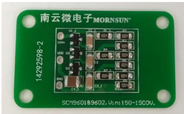
图 1 基于 SCM9601 和 SCM9602 的高压启动应用方案
